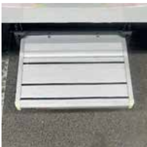
Ulostyöntävä astinlauta kuljettajan ovessa Y0410 i760, i810, i910
