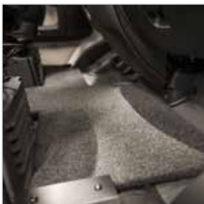
Lämpömatto ojaamossa sekä patterit astinkotelossa (vakiona muissa malleissa)
