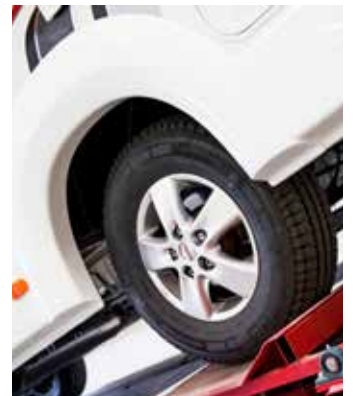
Kestävyyttä simuloidaan täristyspenkissä kokeessa, joka vastaa 100 000 kilometrin normaalia ajoa.
