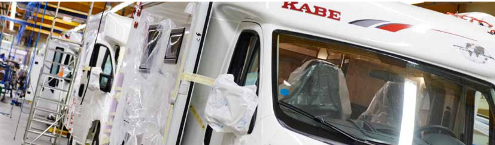
Sadekammiossa matkailuautojen päälle ruiskutetaan vettä kovalla paineella.
