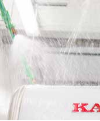
Sadekammiossa matkailuautojen päälle ruiskutetaan vettä kovalla paineella.
