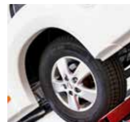
Hållbarhetstest körning. Hållbarhetstest simuleras i en skakbänk motsvarande 10 000 mil normal körning.
