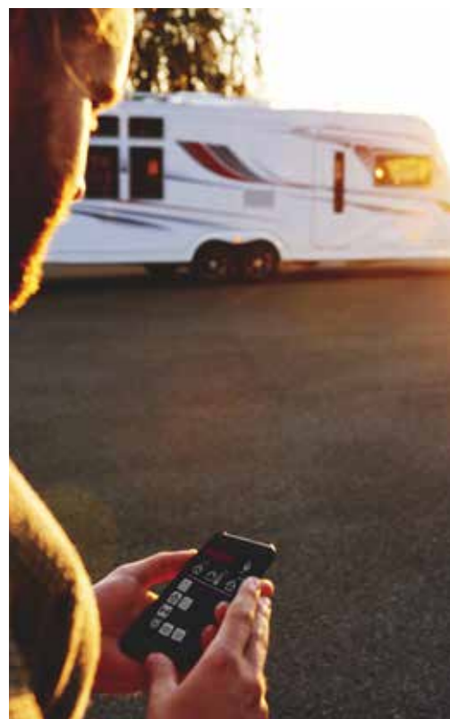
KABE Smart D Remote. KABE Smart D Remote gör det möjligt att fjärrstyra husvagnens manöverpanel var du än befinner dig, via en app i din smartphone. Den är uppbyggt kring en 4G-router med externa antenner och ett mobilt modem. Förutom att kunna styra uppvärmning, belysning och hålla koll på husvagnens funktioner och larm via telefonen får du också tillgång till riktigt bra trådlös internetuppkoppling på resan.
