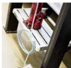
Hållfastheten. Tryck används för att testa hållfastheten hos produkterna.
