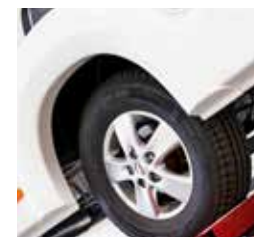
Sterktetest tijdens het rijden. Op een schudbank wordt de soliditeit getest, deze simulatie komt overeen met 100.000 km normaal rijden.
