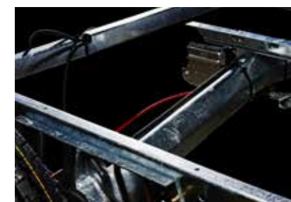
Extra torsiestijf chassis. Extra balken tussen de lengtebalen van het chassis voor een stabielere vloer en een extra stijf chassis. Tussenbalken voor optimale stabiliteit. Het chassis is voorzien van steunen op de buitenste lengtebalen waardoor het gewicht beter wordt verdeeld op de plaats waar vloer en wand samenkomen. De carrosserie is bestand tegen zeer hoge belasting, bijvoorbeeld wanneer er een dikke laag sneeuw op het dak ligt.
