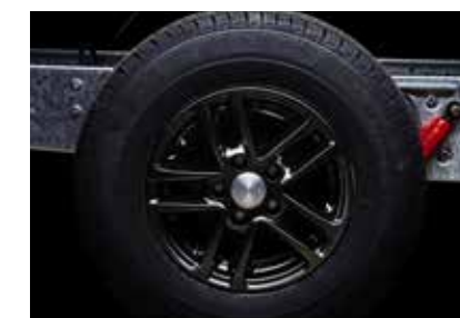
Banden en koppeling. De banden op de eenassers zijn van een type met 8 lagen. De dubbelassers hebben 14" laagprofielbanden. Alle caravans hebben frictiekoppeling.
