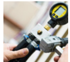
Gassysteem. Het flessengassysteem wordt onder druk getest.
