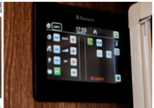
Met KABE SMART D regelt u de verwarming en de verlichting en houdt u controle op het verswater-niveau, de accucapaciteit en nog veel meer. Alles op één scherm!
