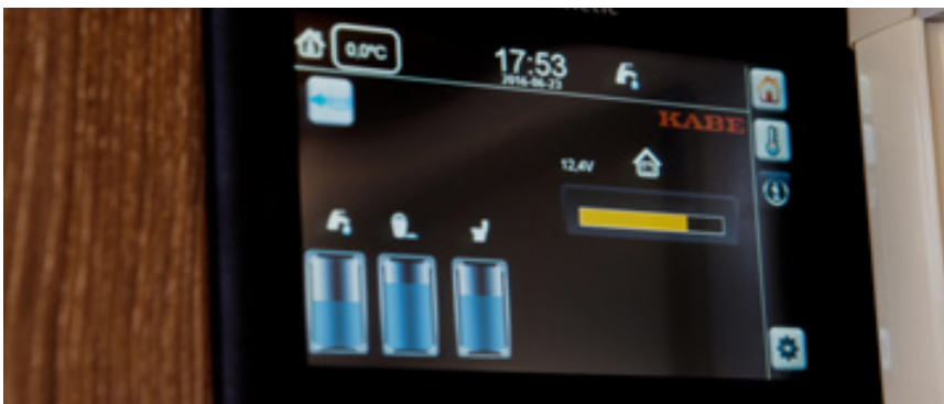
De actuele statusinformatie van het verswaterniveau, het grijswaterniveau en de accucapaciteit worden op overzichtelijke wijze aangegeven.
