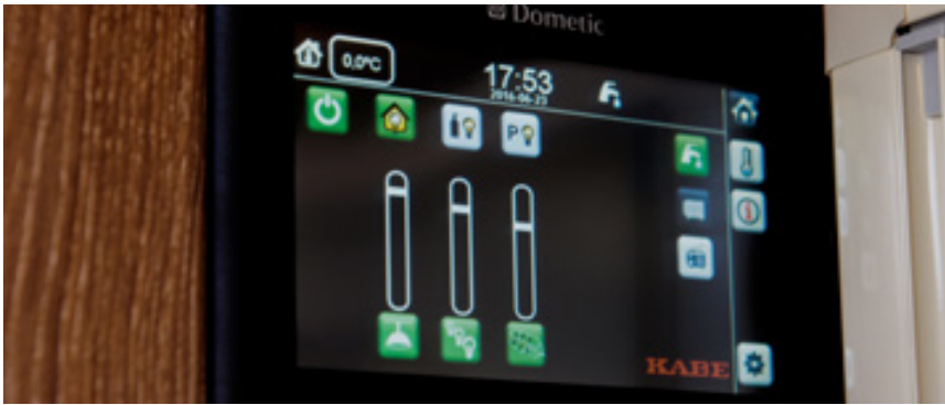
Op het startscherm ziet u alle knoppen voor de verlichting en een digitale schuifregelaar voor de dimmer. Verder kunt u hier de binnen- en buitentemperatuur en de tijd aflezen.
