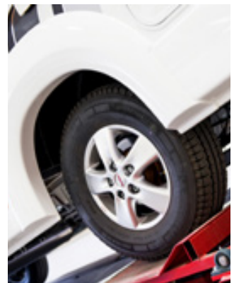
Op een schudbank wordt de soliditeit getest, deze simulatie komt overeen met 100.000 km normaal rijden.
