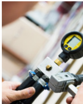
Het flessengassysteem wordt onder druk getest.
