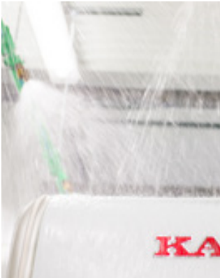
In de regenkamer worden de voertuigen onder hoge druk bespoten.
