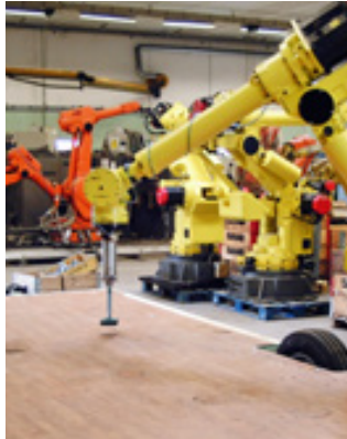
Udholdelsestests foretages på de forskellige karosseridele.
