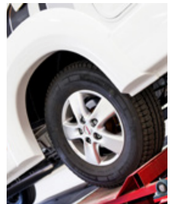
Holdbarhedstests simuleres på et rystebord, der svarer til 100.000 km normal kørsel.
