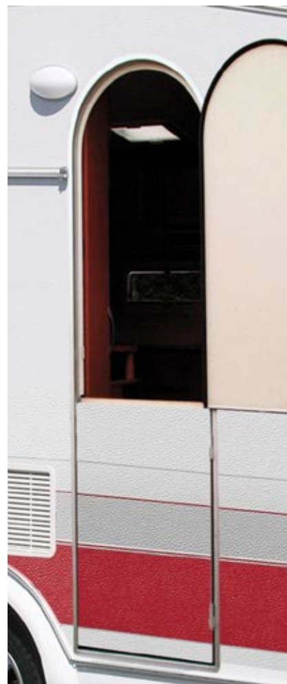
Gedeelde deur De deur heeft een vlakke binnenzijde en kan in twee delen worden geopend.
