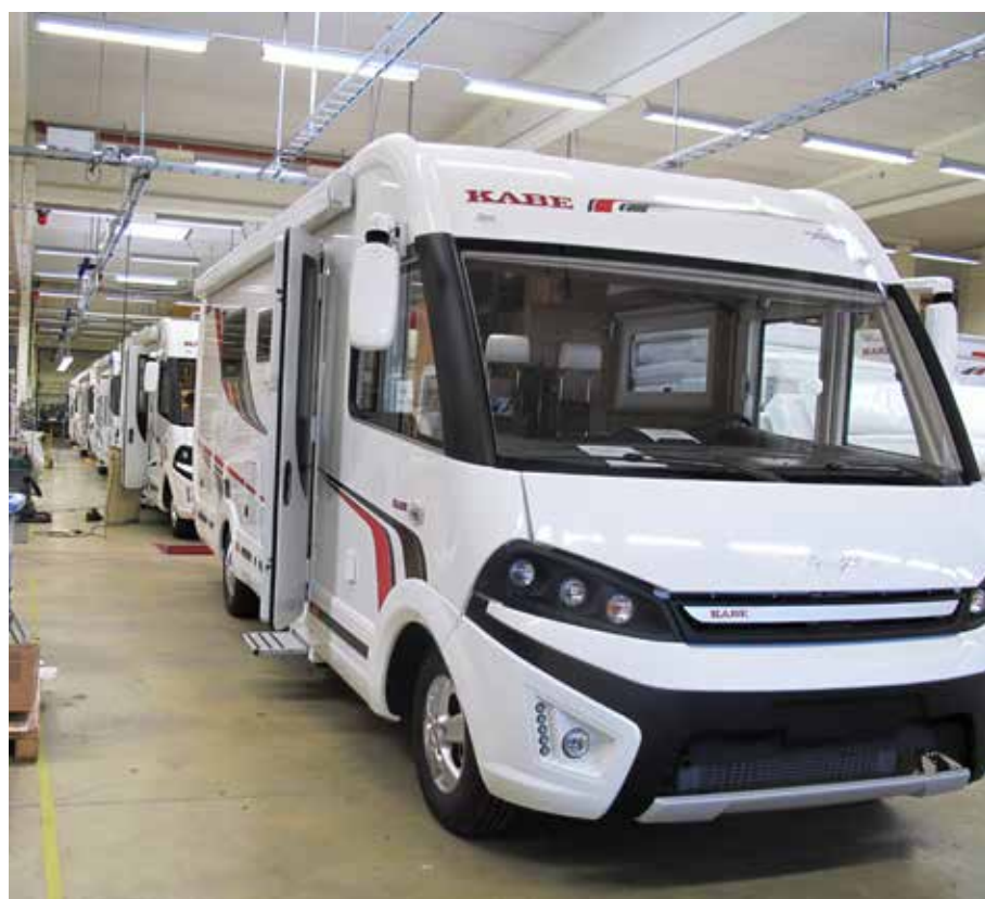
Kalusteet ja sisustukset rakennetaan itsekantavina moduuleina, jotka asennetaan auton alustalle ennen seinää.
