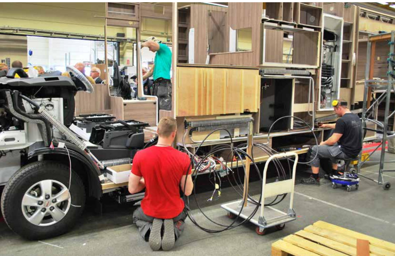
Kalusteet ja sisustukset rakennetaan itsekantavina moduuleina, jotka asennetaan auton alustalle ennen seinää.
