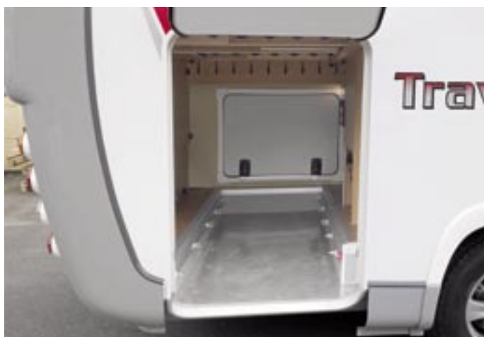
Inifrån garaget kommer man också åt bland annat bodelsbatteriet.
