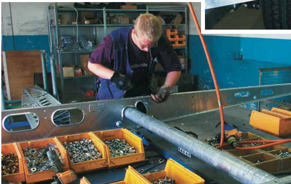
Kabes husvagnschassier skiljer sig från de flesta andras genom sina många tvärbalkar och genom utliggarna som tar upp tyngden från väggar och tak. Det är en mängd smådetaljer som ska monteras ihop, innan chassiet är komplett.
