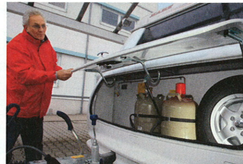
Große Klappe: Der Gaskasten beheimatet zusätzlich das Reserverad und einen optionalen Außengasanschluss.
