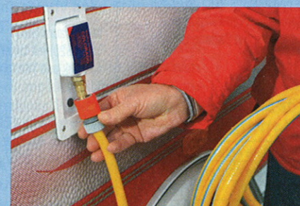
Frischwasser: Der Citywasseranschluss sorgt beim Kabe für einen stets gefüllten Frischwassertank. Er ist Bestandteil des Systems.
