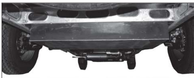
Gråvattentanken monterad mellan husbilens bakhjul.
