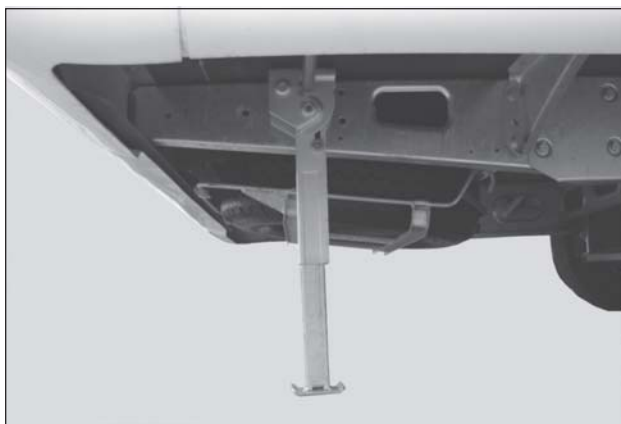
Stödbenet nervevat för att stabilisera husbilen.
