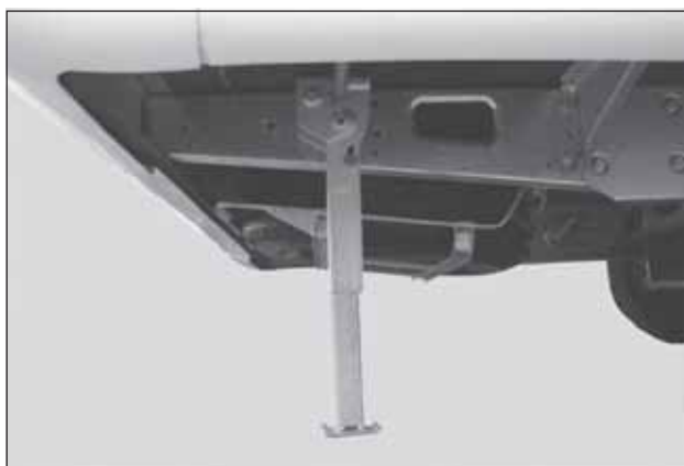
Stödbenet nervevat för att stabilisera husbilen.
