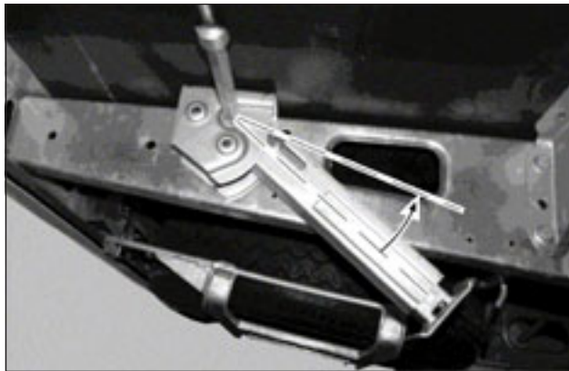
Stödbenet ska vevas upp ända till sitt övre läge.
