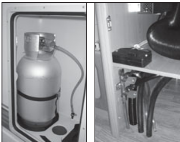
Huvudkran på gasolflaskan och gasolventil till pannan.
