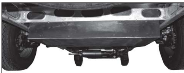
Harmaavesisäiliö on matkailuauton takapyörien välissä.
