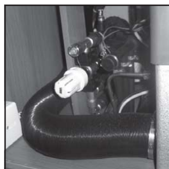
Lattialämmityksen termostaatti (vain tietyt matkailuautot).
