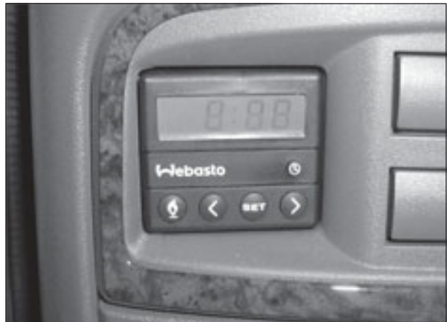
Polttonestekäyttöisen Webasto-lämmittimen ohjauspaneeli.
