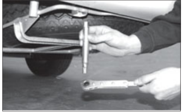
Löysää ruuvia, jolla ripustuskoukku on varmistettu.
