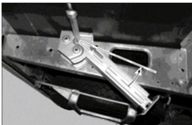
Tukijalka on veivattava perille saakka yläasentoonsa.
