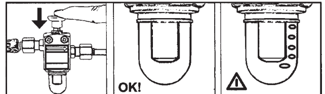
Tarkasta nestekaasujärjestelmä vuodonilmaisimella 10 sekunnin ajan. Kuplat ovat merkki vuodosta.
