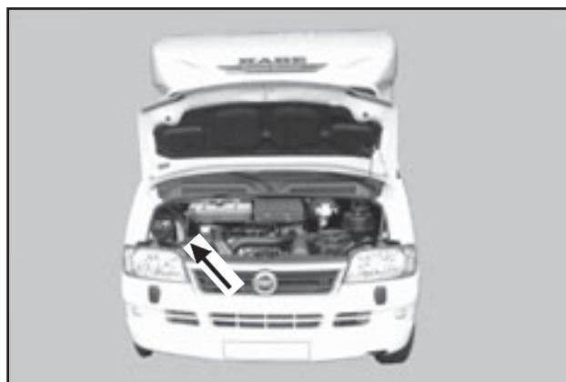
Latausvirran jakaja (R) on asennettu moottoritilaan.
