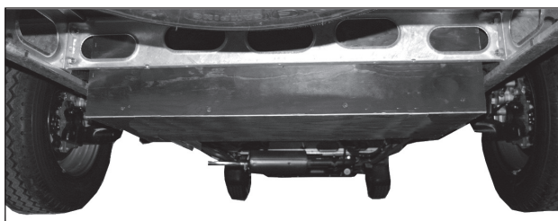
Harmaavesisäiliö on asennettu matkailuauton taka-akselin viereen.
