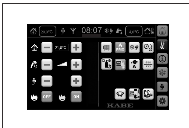
Bedientafel des Wohnmobils, Menü Heizung.
