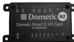
En af elsystemets enheder N2-N6. Dometic Smart D I/O Card.
