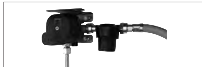
Gastryksensør med kollisionsensør (og filter).
