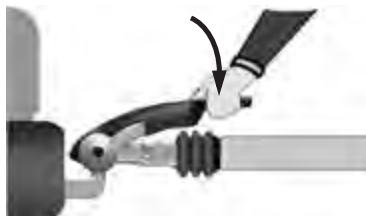
Angekoppelt und stabilisiert
