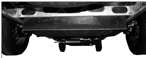
Gråvannstanken er montert ved bobilens bakaksel.
