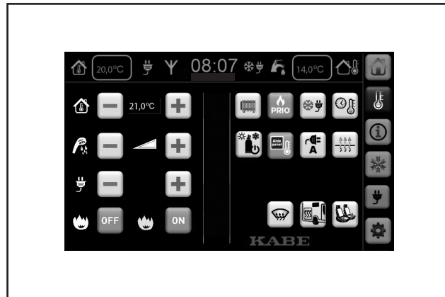
Bedieningspaneel van de camper, menu Verwarming.
