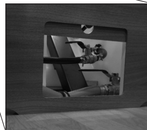
Kranen van de verswatertank: Overvulbeveiliging 20 liter respectievelijk aftappen bij het legen van de verswatertank.
