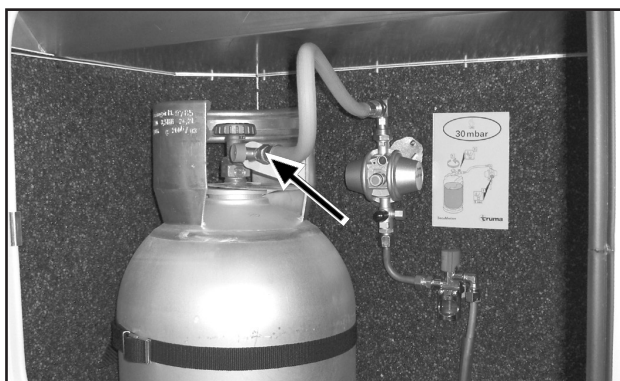
Avaa letkunrikkoventtiilit painamalla painiketta. Jos letkunrikkoventtiili on kiinni, ei kaasulaitteita voi sytyttää.
