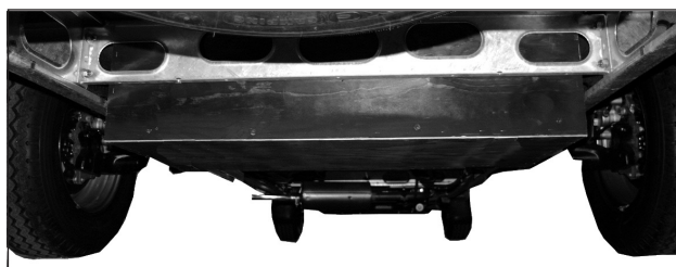
Harmaavesisäiliö on asennettu matkailuauton taka-akselin viereen.
