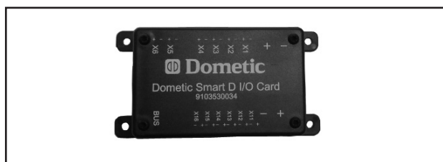
Einheit N2 des Bus-Systems trägt die Bezeichnung: Dometic Smart D I/O Card.
