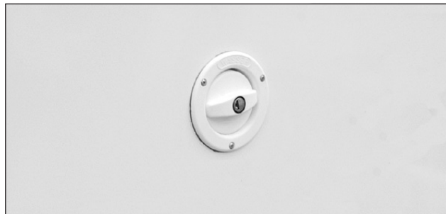
Nachfüllstutzen für Frishwasser.
