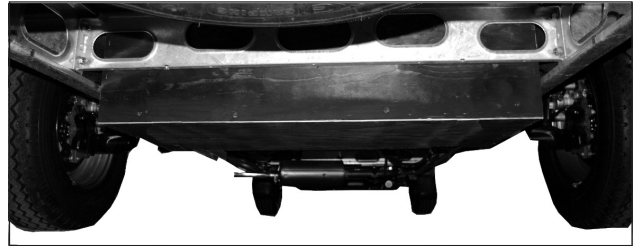
Der Grauwassertank ist bei der Hinterachse des Wohnmobils montiert.
