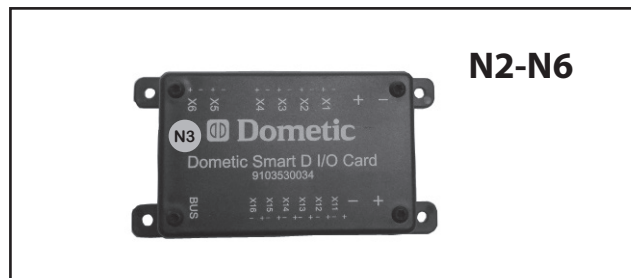
Bildet viser en av elsystemets enheter N2-N6. Dometic Smart D I/O Card.
