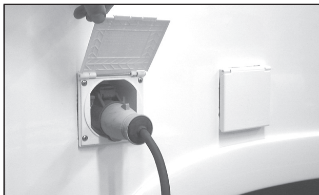
Oppvarming med elpatron forutsetter 230 V tilførsel.
