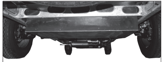
De grijswatertank bevindt zich bij de achteras van de camper.
