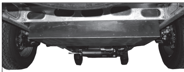
Harmaavesisäiliö on asennettu matkailuauton taka-akselin viereen.
