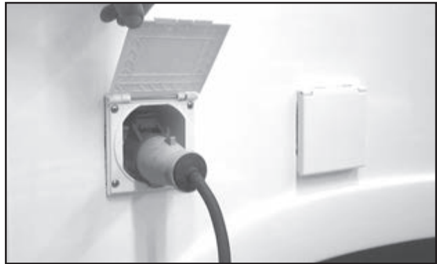
Sähköpatruunalla tapahtuva lämmitys on mahdollinen auton ollessa kytkettynä 230V-verkkoon.
