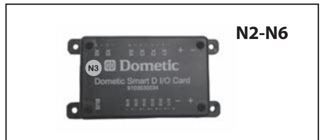
Die Abbildung zeigt die Einheiten N2-N6 des Elektrosystems. Dometic Smart D I/O Card.
