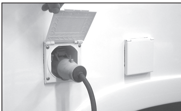
Oppvarming med elpatron forutsetter 230 V tilførsel.
