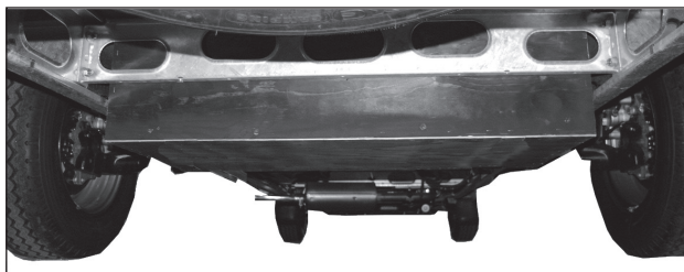
Harmaavesisäiliö on matkailuauton takapyörien välissä.
