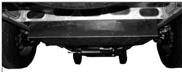
Gråvannstanken montert mellom bobilens bakhjul.
