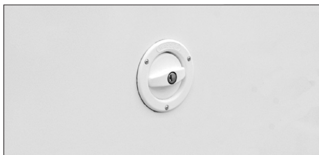
Påfyllning av färskvatten.
