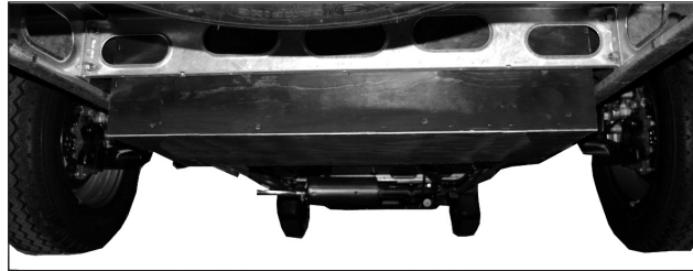
Gråvattentanken monterad mellan husbilens bakhjul.
