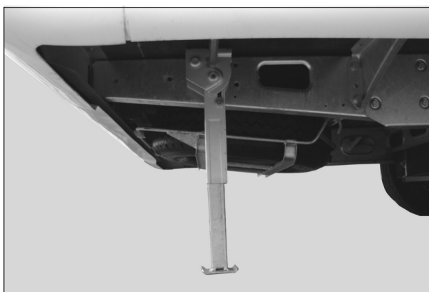
Stödbenet nervevat för att stabilisera husbilen.
