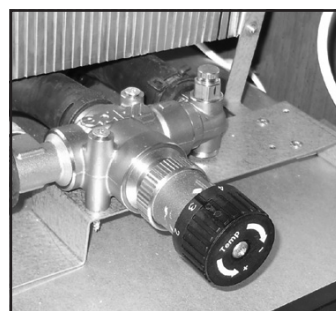
Shuntventil för golvvärme (endast vissa husbilar).
