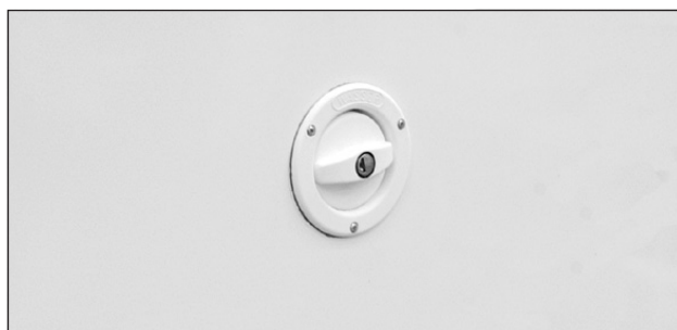
Påfylling av ferskvann.
