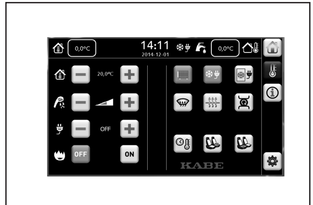
Bedientafel des Wohnmobils, Menü Heizung.
