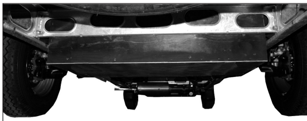
Harmaavesisäiliö on matkailuauton takapyörien välissä.
