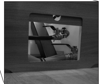
Ventile für den Frischwassertank: Überfüllschutz 45 Liter bzw. Ablassventil beim Entleeren des Frischwassertanks.
