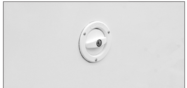
Nachfüllstutzen für Frishwasser.
