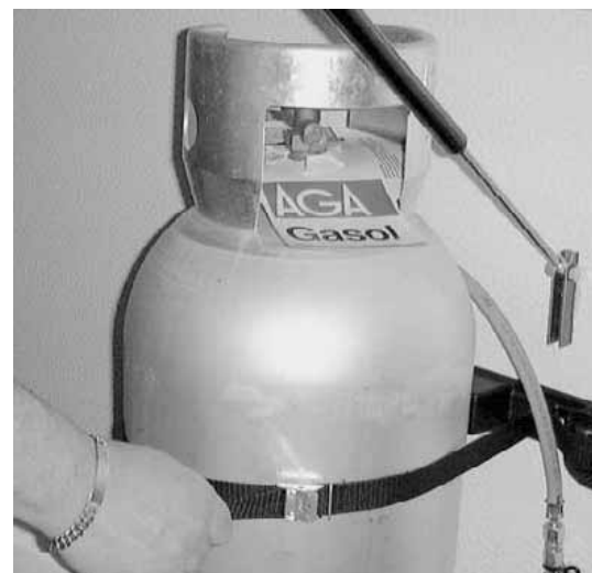
Kontroller at gassflasken er ordentlig festet.
