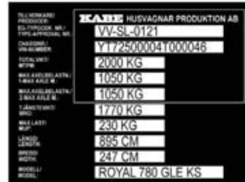
Kombinert typeskilt og inspeksjonsskilt for det svenske markedet.
