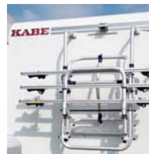
Pyöräteline Y0335, Y0403 Kolmelle pyörälle, käsikäyttöinen hissi.
