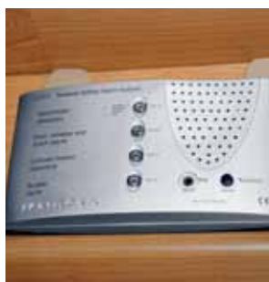
Sicherheitsalarm Y0314 Alarm für u.a. schwere und leichte Betäubungsgase, Gasleckage und Brandrauch.
