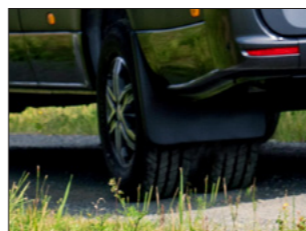
Tvillinghjul 4 x 2 og 4 x 4: 5 tonn, ca. 850 kg ekstra lastvekt, vogntogvekt 7 tonn
