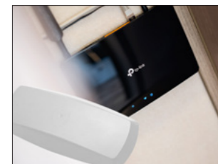
Ekstern antenne til router
