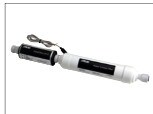
"Vandrensning" - ALDE AquaClear UV-C (til fyret ALDE Compact 3030). Effektiv vandrensning, der beskytter brugerens helbred på en skånsom og miljøvenlig måde. Systemet fjerner uønskede vira og bakterier, pesticider og kemikalier. Vandet desinficeres med UVC-lys genereret af lysdioder. Derefter løber vandet også gennem kulfiltre, der giver lugtfrit vand uden dårlig smag eller farve.
