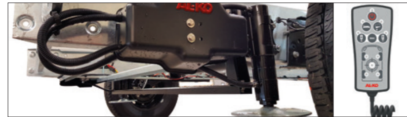
AL-KO HY4 hydraulische steunpoten. Zet uw camper waterpas met een druk op de knop via het controlepaneel. Met een volgende druk op de knop kunt u een lichte helling instellen, met een laatste druk op de knop worden de steunpoten ingetrokken. HY4 kan ook volledig handmatig worden aangedreven zodat je de steunpoten naar wens kunt aanpassen. Elke steunpoot heeft zijn eigen motor en het hele systeem is op het chassis gemonteerd. Er gaan geen slangen de camper in. Standaard op de Imperial, als optie op de andere modellen.
