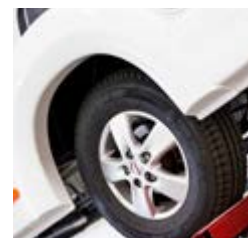
Holdbarhetstest kjøring. Holdbarhetstest simuleres i en vibrasjonsbenk og tilsvarer 10 000 mil normal kjøring.
