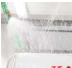
Regnkammer. I regnkammeret sprutes det vann på bobilene under høyt trykk.
